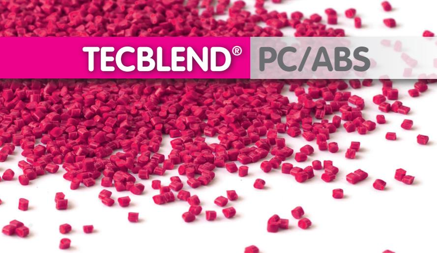
Lega di PC/ABS colorata e naturale, per usi generali, alto impatto, alta fluidità, termoresistente.
